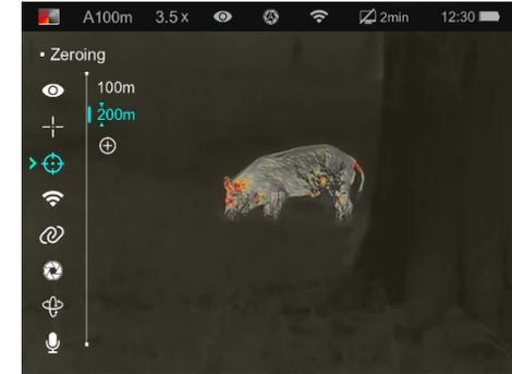
En la interfaz de puesta a cero de retícula, se puede ajustar la posición X/Y de la retícula para coincidir con el punto de impacto.
